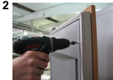
2: Skru av møbeldør. Skru av kjøledør og legg den ned på et flatt underlag.
