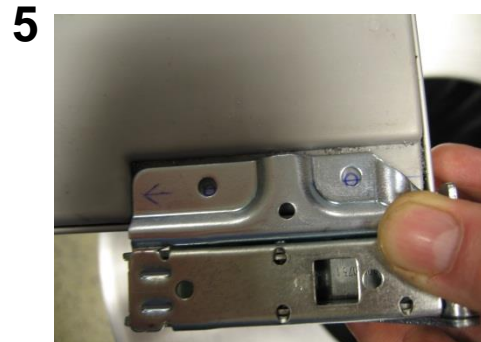
5. Plasser hengsle i senter av oppmerket linje og mot plastkant (se pil på bilde), og merk av hull.
