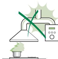
Koble kjøkkenviften til røkkanalen med et rør med en diameter på min. 120 mm. Røret må være så kort som mulig.
