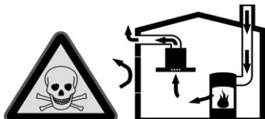
Rumluftsugende, varmeafgivende apparater (f.eks. gas-, olie-, træ- eller kuldrevne ovne, varmeapparater med kontinuerligt flow eller vandvarmere) indtager forbrændingsluft fra det lokale, hvori de er installeret og udleder afledningsgasser til luften via et gasudledningssystem (f.eks. en skorsten).
