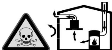
Luftberoende, värmelstrande inomhusapparater (t.ex. gas-, olje-, trä- eller koldrivna värmeapparater, kontinuerliga flödesvärmare eller vattenvärmar) tar förbränningsslut från den lokal i vilken de installerats och släpper ut avgas i fria luften genom ett avgassystem (t.ex. en skorsten).
