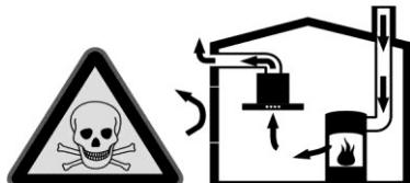
Huoneilmasta riippuvat lämpöä tuottavat laitteet (esim. kaasu, öljy, puu tai hiilikäyttöiset lämmittimet) saavat palamisilman huoneesta johon ne on asennettu ja poistavat pakokaasut ulkoilmaan poistokaasujärjestelmän kautta (esim. piipu).
