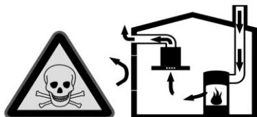
Luftberoende, värmelstrande inomhusapparater (t.ex. gas-, olje-, trä- eller koldrivna värmearraper, avgaser kontinuerliga flödesvärmare eller vattenvärmar) tar förbränningluft från den lokal i vilken de installerats och släpper ut avgas i fria luften genom ett avgassystem (t.ex. en skorsten).
