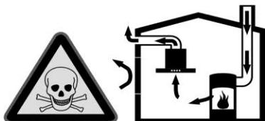
Apparater i rommet som produserer varme (f.eks. gass, olje, tre eller kuldrevne varmeovner, varmestrømsovner eller varmtvannsberedere) som får forbrenningsluft fra rommet de er installert i, og som avgir avgasser i luften via et avgassystem (f.eks. en pipe).
