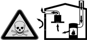
Huoneilmasta riippuvat lämpöä tuottavat laitteet (esim. kaasu, öljy, puu tai hiilikäyttöiset lämmittimet) saavat palamisilman huoneesta johon ne on asennettu ja poistavat pakokaasut ulkoilmaan poistokaasujärjestelmän kautta (esim. piippu).
