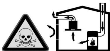
Rumluftsugende, varmeafgivende apparater (f.eks. gas-,olie-, træ- eller kuldrevne ovne, varmeapparater med kontinuerligt flow eller vandvarmere) indtager forbrændingsluft fra det lokale, hvori de er installeret og udleder afledningsgasser til luften via et gasudledningssystem (f.eks. en skorsten).
