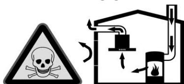
Apparater i rommet som produserer varme (f.eks. gass, olje, tre eller kulldrevne varmeovner, varmestrømsovner eller varmtvannsberedere) som får forbrenningsluft fra rommet de er installert i, og som avgir avgasser i luften via et avgasssystem (f.eks. en pipe).
