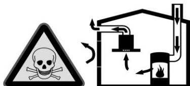
Luftberoende, värmelstrande inomhusapparater (t.ex. gas-, olje-, trä- eller koldrivna värmearrater, avgaser kontinuerliga flödesvärmare eller vattenvärmar) tar förbränningluft från den lokal i vilken de installerats och släpper ut avgas i fria luften genom ett avgassystem (t.ex. en skorsten).
