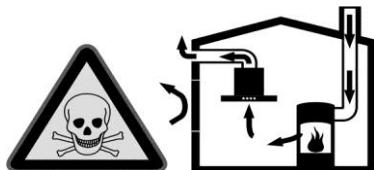
Huoneilmasta riippuvat lämpöä tuottavat laitteet (esim. kaasu, öljy, puu tai hiilikäyttöiset lämmittimet) saavat palamiselmaan huoneesta johon ne on asennettu ja poistavat pakokaasut ulkoilmaan poistokaasujärjestelmän kautta (esim. piipu).
