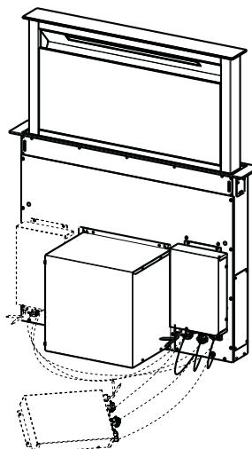
⚠️ **Advarsel:** Lad ikke forbindelseskassen være i kontakt med gulvet, når apparatet installeres.
