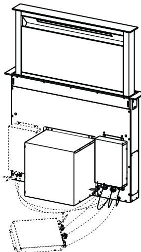
**⚠️ Advarsel:** Ikke installér produktet slik at koblingsboksen er i kontakt med gulvet.
