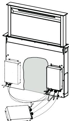
**⚠️ Varning...: Installera inte produkten med kopplingsdosan i kontakt med golvet.**
