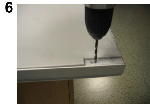
6. Bor opp nye 5 mm hull i oppmerkede punkter. Maks 10 mm dype.
